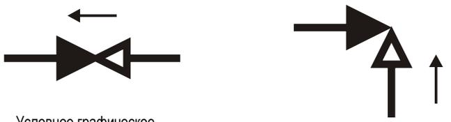
Условное графическое обозначение клапана обратного **проходного** на чертежах и схемах, стрелка указывает направление потока.
