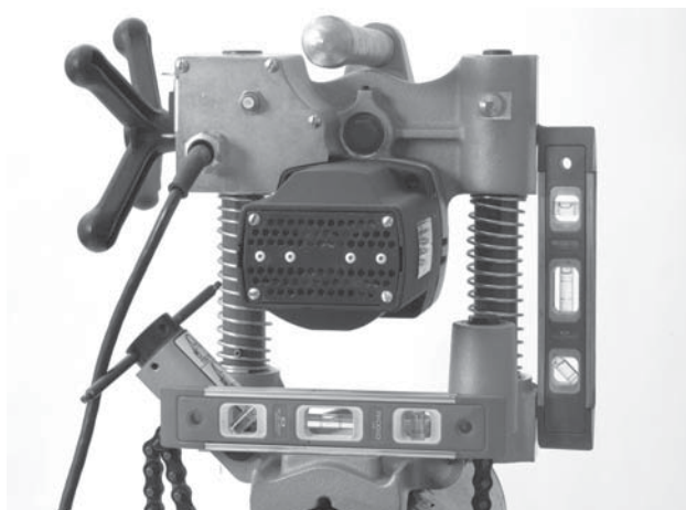
Figure 10 – Mise de niveau de la HC-300
