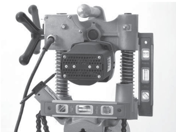
Figura 10 – Nivelación de la HC-300
