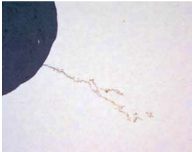
Трещина, отходящая от резьбы, вид под микроскопом
