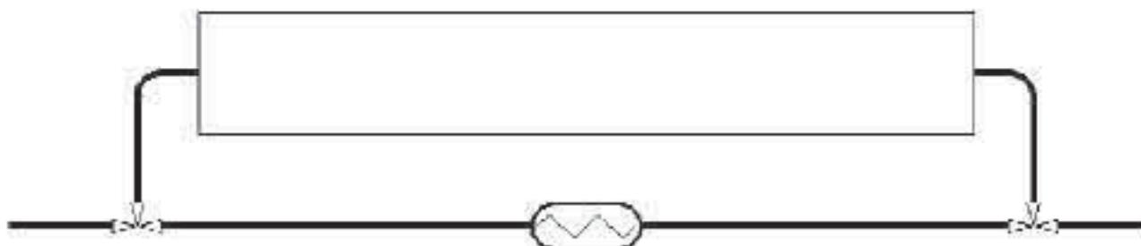
В случае обходных линий, например для конвекторов, возникают разности температур, и тем самым, – напряжения.
