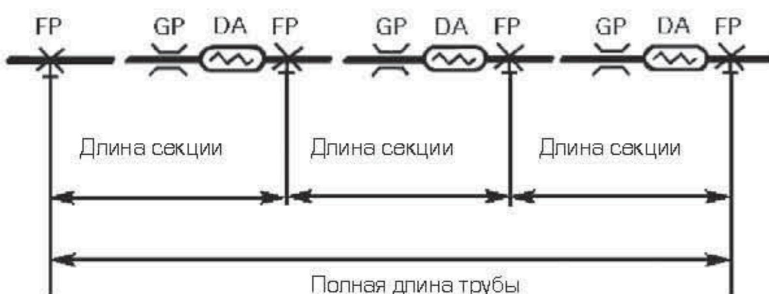
Несколько компенсаторов растяжения в одном трубопроводе могут быть смонтированы в соответствии с данным рисунком. Полную длину трубы необходимо разбить на отдельные секции, ограниченные точками жесткого крепления. Для каждой секции устанавливается один компенсатор растяжения.
