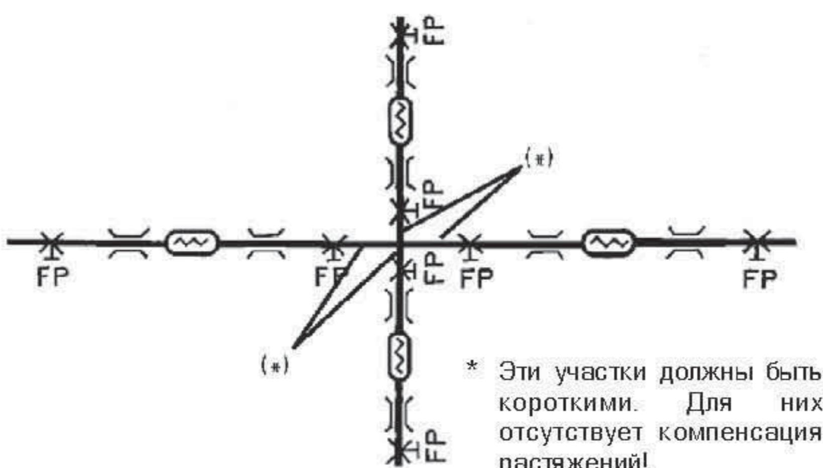
Ответвления или пересечения должны быть реализованы в качестве точек жесткого крепления [FP], как изображено на рисунке, так как в данном случае невозможна передача сдвиговых усилий.
