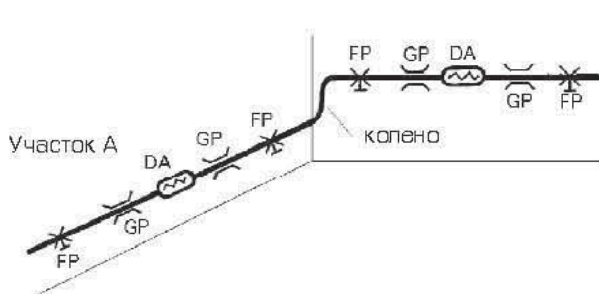
Точки жесткого крепления и компенсаторы растяжений на участках А и В предотвращают действие колена, как рычага, и тем самым, ликвидируют напряжения кручения на участках А и В.
