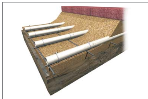
Напольное отопление на открытых пространствах
