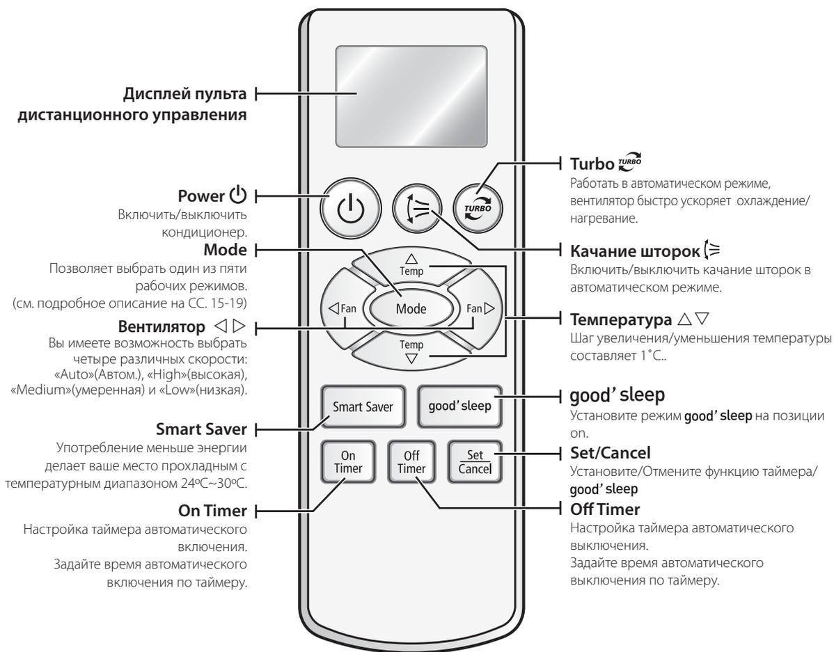
Когда вы нажимаете кнопку, один короткий телеметрический сигнал будет звучать и один индикатор передачи ( ) является на дисплее дистанционного управления.
