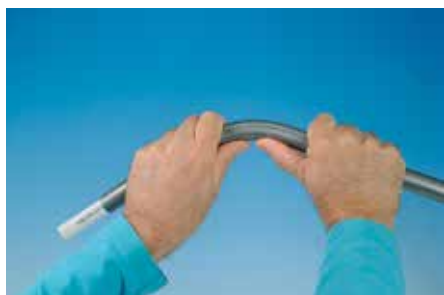
Гибка с помощью внешней гибочной пружины
