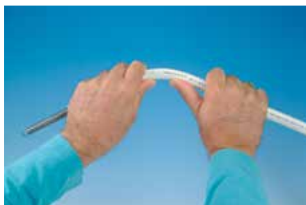
Гибка с помощью внутренней гибочной пружины
