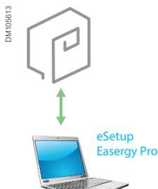
Подключите ПК с запущенной программой eSetup Easergy Pro к USB-порту реле Sepam P3 во время ввода в эксплуатацию, чтобы настроить параметры и проверить его работу.
