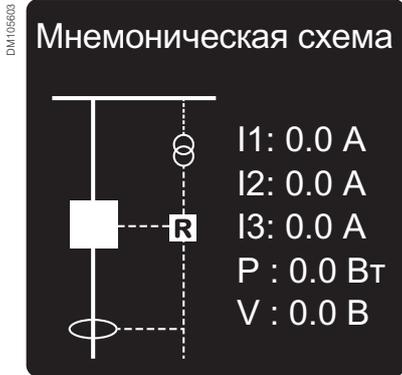
Однолинейная схема энергосистемы
