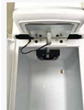
Fig. 9 : intérieur du socle de l'AQA drink Pro 20 sans réservoir d'eau usée suspendu
