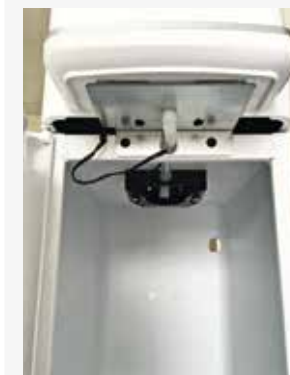
Fig. 9: Armário do AQA drink Pro 20 no interior, sem depósito de água suspenso
