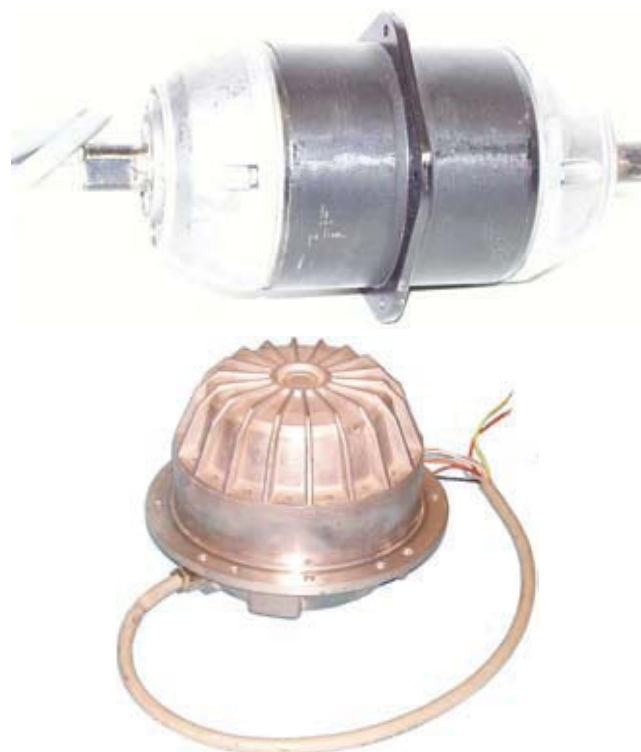
Рисунок 3.4. Электродвигатели Rosenberg с внешним ротором
