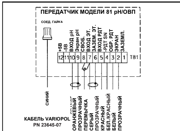
РИСУНОК 2-21. Подключение Модели 396VP и 398VP к Модели 81
