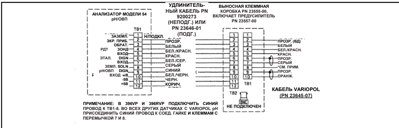
РИСУНОК 2-32. Подключение Модели 396VP и 398VP к Моделям 54 и 54е через Выносную клеммную коробку
