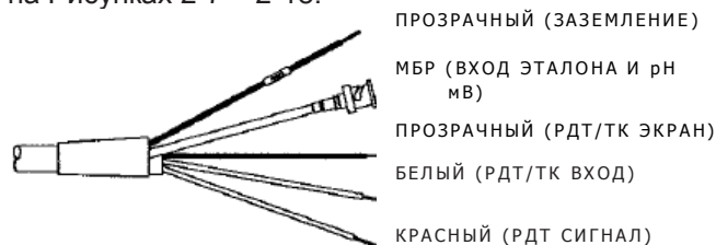
РИСУНОК 2-7. Стандартный вариант проводки Моделей 396, 397 и 398 при использовании с Моделями 1054А, 1054В, 2054 и Предварительными усилителями PN 22698-02 и 22698-03.
