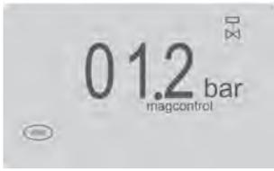
После включения устройства в электросеть (вилка Shuko) на дисплее выводится значение давления в системе. Устройство 'magcontrol' активировано и находится в режиме блокирования (stop) (LC=0).
