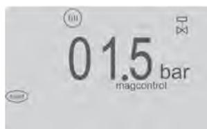
В случае превышения установленного в меню пользователя значения давления  $p_0$  на более, чем 0,2 бара, электромагнитный клапан закрывается автоматически через 10 сек.
