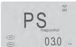
Это сообщение появляется только на дисплее 'magcontrol'. Установите давление срабатывания предохранительного клапана на теплопроизводителе и подтвердите выбор нажатием клавиши «ok».
