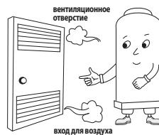
**В котлах с системой принудительного отвода дыма(FE) нельзя подсоединять вторую дымоотводящую трубу.**
