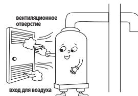
**Обязательно установите впускное и вентиляционное отверстия.**
