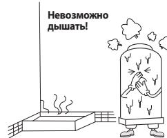
**Не устанавливайте котел в местах, где присутствует агрессивная среда в виде паров аммиака, хлора, серы и кислоты**
