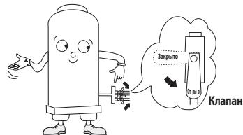
**Ни в коем случае нельзя соединять кабель датчика низкого уровня воды и заземляющий кабель.**
