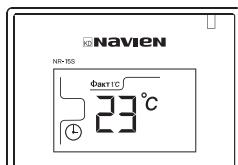
После установки обогрева по таймеру, время на дисплее температуры исчезнет и вновь будет отображаться текущая температура. После наступления зафиксированного времени загорится индикатор горения и котел автоматически включится и начнет работать.
