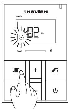
При выборе функции таймера отопления мигает значок .
