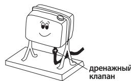
Если полностью открыть дренажный клапан существует опасность утечки большого количества топлива. Нет необходимости его полностью открывать, поскольку в баке находится небольшое количество воды.
