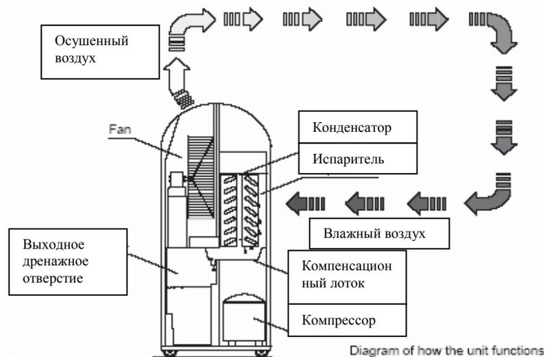
Осушенный, охлажденный воздух вновь разогревается в **конденсаторе** (радиаторе), а затем выводится наружу с температурой примерно на 5 градусов выше комнатной температуры. Этот воздух, который теперь стал суше, вновь смешивается с окружающим воздухом. Относительная влажность воздуха постепенно сокращается до желательного значения относительной влажности, с помощью непрерывной циркуляции внешнего воздуха через установку.
