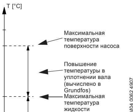
**Рис. 12** Расчёт максимальной температуры поверхности
