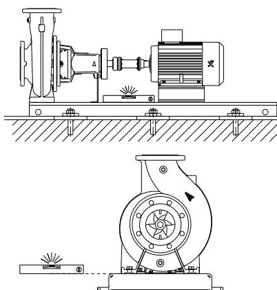
Рис. 3 Горизонтальный монтаж изделий
