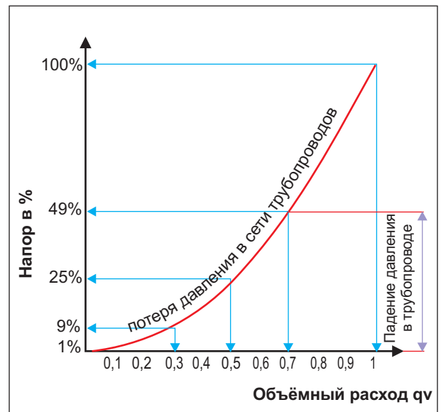
Рис. 1-8. Характеристика сети трубопроводов
