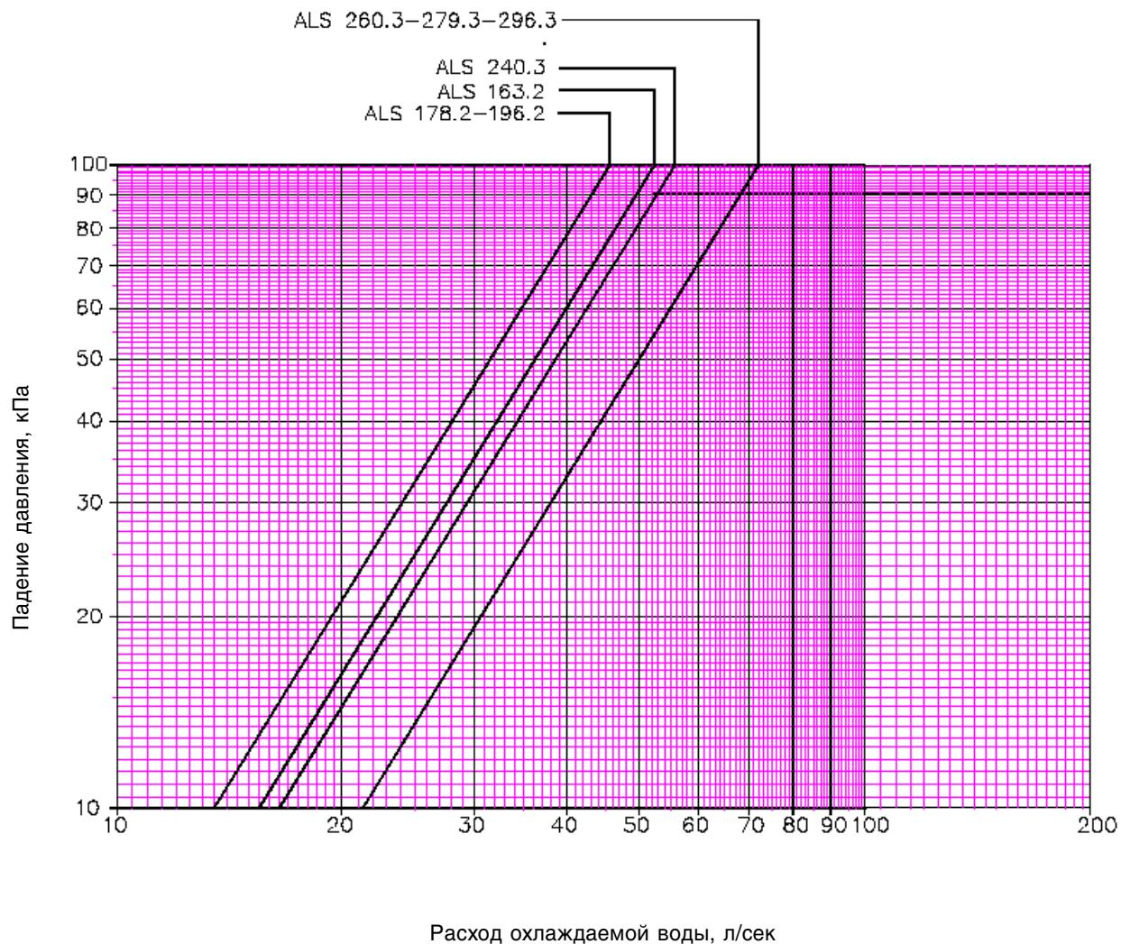
**ХАРАКТЕРИСТИКИ ЧИЛЛЕРОВ ALS "D" 163.2 - 279.3 ПРИ ПОЛНОЙ РЕКУПЕРАЦИИ ТЕПЛОТЫ
