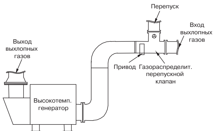
Пример установки газораспределительного перепускного клапана
