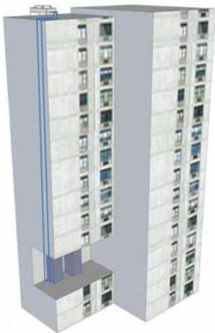
Пример размещения кондиционера и сухого охладителя
