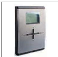
Термостат TCU 700 может управлять 1-10 обогревателями SAFIR II в одном помещении. Коммуникация термостата и обогревателя происходит с помощью радиосигнала. Термостат позволяет использовать режим экономии электроэнергии; также возможно подключение к системе ORION 700.
