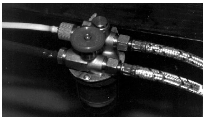
Для эксплуатации только в однолинейной системе необходимо вывинтить перепускную заглушку в отверстии обратной линии и закрыть это отверстие металлической заглушкой с уплотнением. ②.
