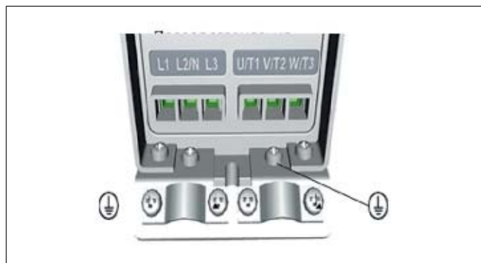
Рисунок 4. Присоединение заземления (PE) к клемме защитного заземления VACON® 20
