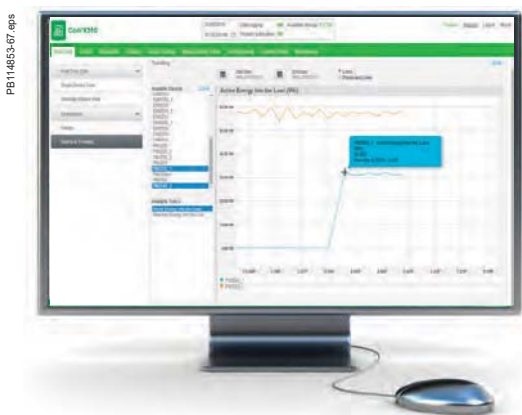
Сравнение архивных трендов от нескольких устройств или по нескольким параметрам (часть экрана)
