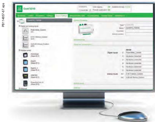
Страница параметров устройства (часть экрана), отображаемая после автоматического обнаружения Com'X, позволяющая настраивать устройства и выбирать данные для ведения журнала и публикации
