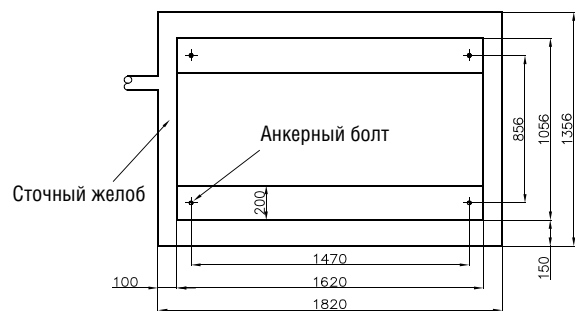
Чертеж, содержащий монтажные размеры модуля
