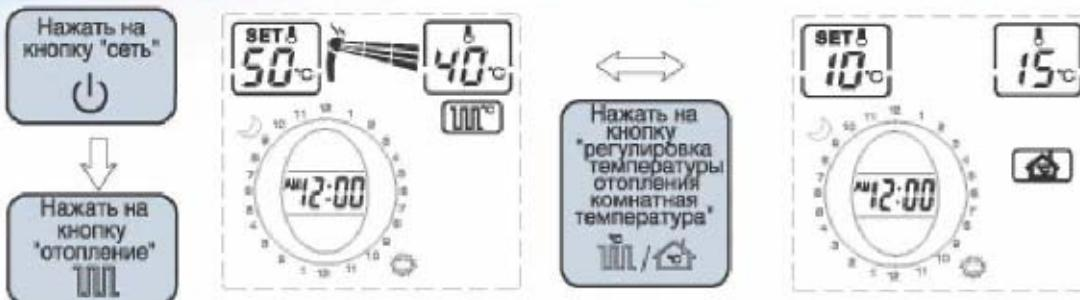
1. Смена режима управления системой отопления по температуре воды в бойлере или по температуре воздуха в отапливаемом помещении происходит нажатием кнопки "регулировка температуры отопления/комнатная температура".
