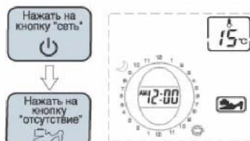
Этот режим используется при отсутствии людей дома. Для защиты системы отопления от замерзания воды - циркуляционный насос прогоняет воду в системе. Если в системе недостаточно воды, то эта функция блокируется.
