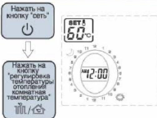
Если бойлер настроен на режим управления по температуре воздуха, сменить при этом задаваемую температуру воды в бойлере можно следующим способом;
