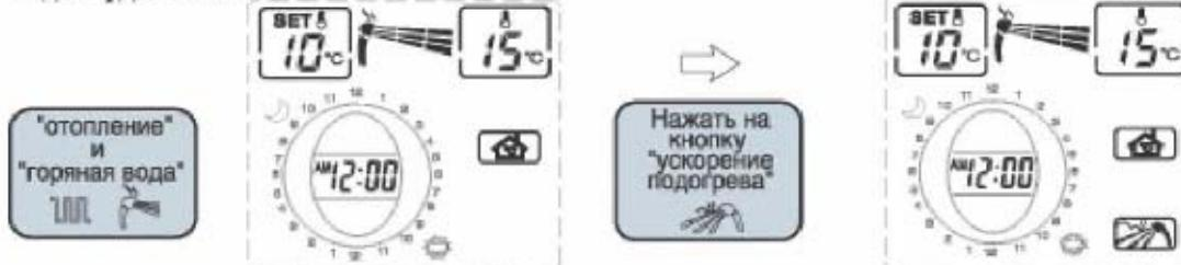
2. Режим ускоренного подогрева воды в бойлере возможен и при совместном использовании отопления и горячего водоснабжения. В этом случае газ в горелке бойлера будет продолжать гореть даже и при отсутствии отбора горячей воды в течение 15 минут. Поэтому для экономии газа после пользования горячей водой необходимо отменить режим ускоренного подогрева повторным нажатием кнопки "ускорение подогрева".
