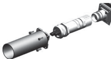
рис. 8: Монтаж защитных гильз (опция)
