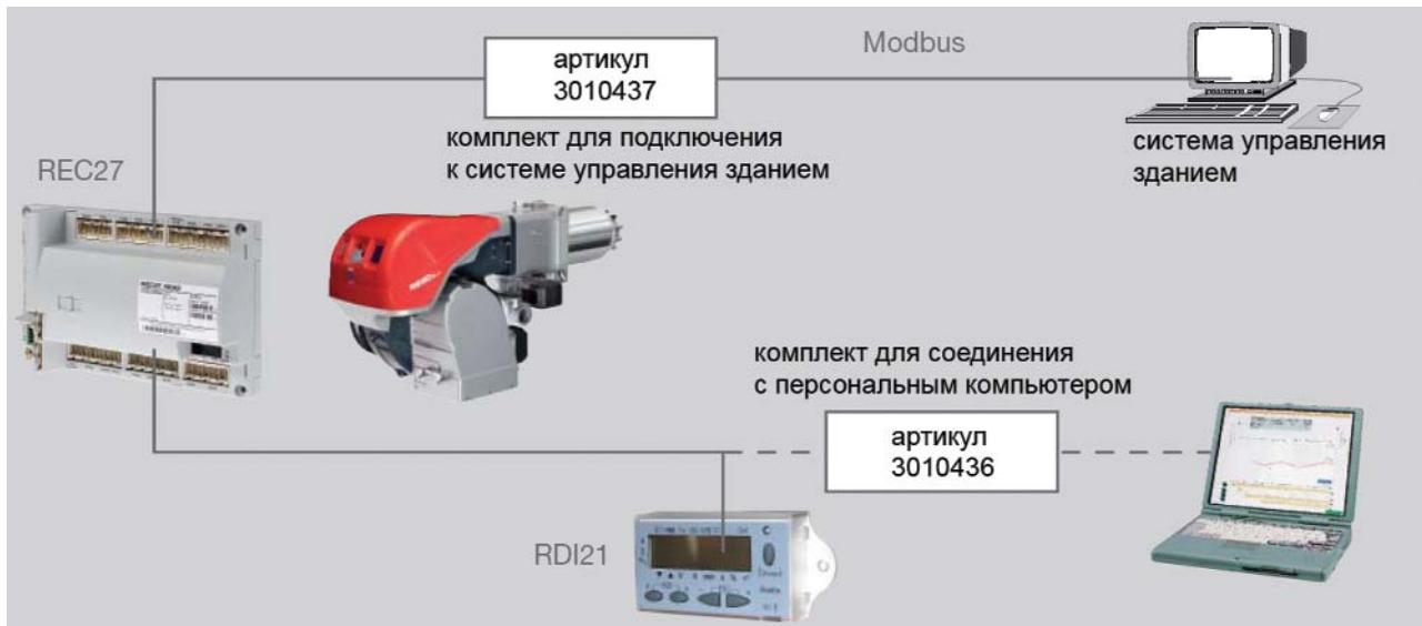
Контроллер горения REC 27 можно подключить к системе управления здания. Это можно сделать с помощью специального комплекта (арт. 3010437). Связь с системой управления зданием осуществляется по протоколу RS 485.
