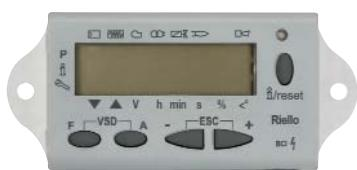
Для связи с контроллером горения используется панель управления **RDI 21**, которая соединяется с менеджером горения системной шиной CAN. Управление горелкой посредством панели **RDI 21** максимально комфортно, благодаря отображению информации на экране дисплея в виде цифровой или символьной информации. Панель управления стандартно устанавливается во все горелки с контроллером горения **REC 27**.
