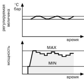
Контроллеры горения **Mini Mk 5 Evolution** и **Mini Mk 6** имеют встроенный ПИД-регулятор, который поддерживает один из выходных параметров теплогенератора (температура или давление) на заданном уровне посредством изменения мощности горелки. Информация о текущем состоянии контролируемого параметра поступает на контроллер горения через датчик температуры или давления. Датчики поставляются по отдельному заказу см. раздел "Дополнительные принадлежности".
