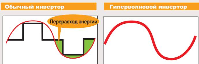
Кривая процесса отклоняется от кривой напряжения на двигателе, отсюда перерасход энергии.
