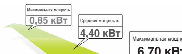
На диаграмме показан широкий диапазон мощности на выходе инверторной модели 1,5 л.с. при работе на обогрев.
