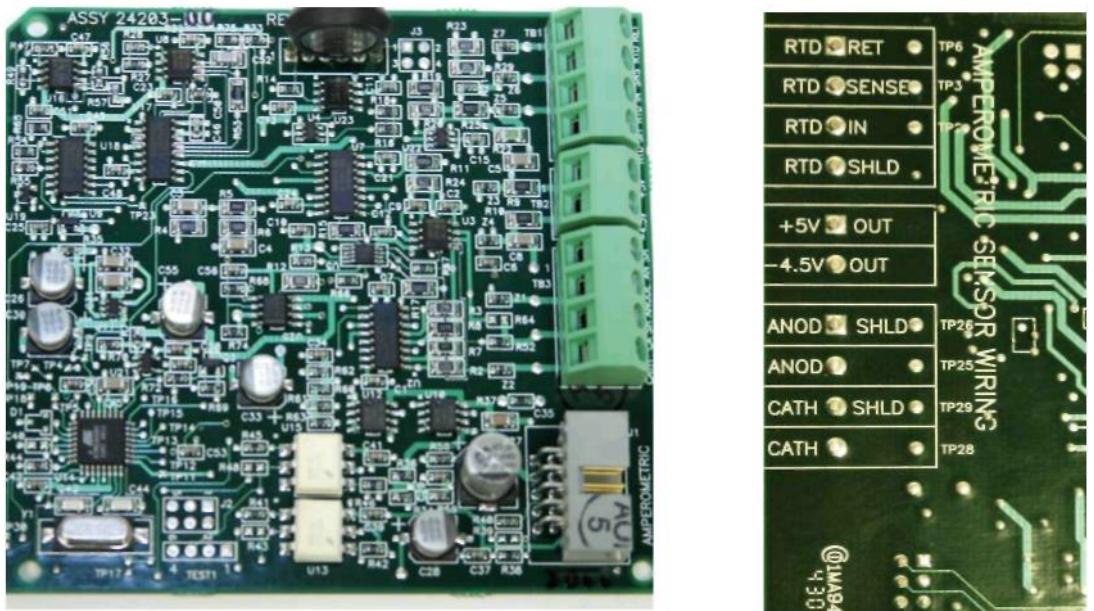
Рис. 3-9. Плата ввода амперметрических сигналов (содержание хлора, кислорода, озона) и выводы кабеля датчика
