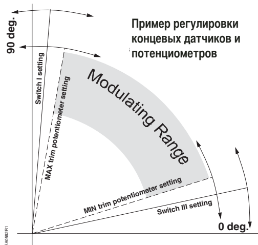
Рис. 13. Установка кулачков и подстроечных потенциометров.
