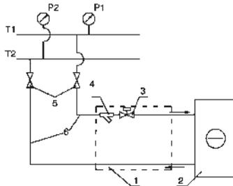
T1 и T2 – подающий и обратный трубопроводы сети холодоснабжения; 1 – узел обвязки; 2 – водяной охладитель; 3 – регулирующий клапан; 4 – водяной фильтр; 5 – запорные вентили; 6 – подающий и обратный трубопроводы от сети холодоснабжения к охладителю.
