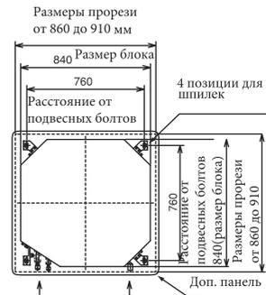
Сторона подсоединения труб Подсоединение дренажной трубы
