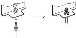
Закрепите основной блок на шпильках прилагающимися гайками и шайбами.
