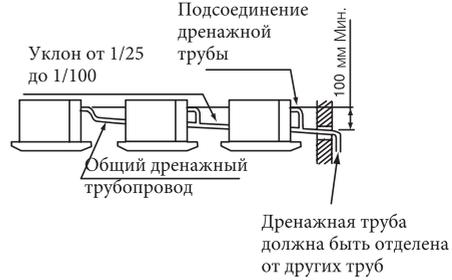
Общая длина a+b+c не более 1,100 мм. В случае, если дренажная труба приподнята на выходе, выполните работу с дренажными трубами, как показано на рисунке выше.
