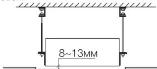
Регулировка гайки на нижней части шпильки позволяет поднять нижнюю часть блока на 8-13 мм выше уровня подвесного потолка (как показано на рис. выше). Затем с помощью уровня отрегулируйте горизонтально остальные углы. Ровность основания должна быть в пределах 1/100.
