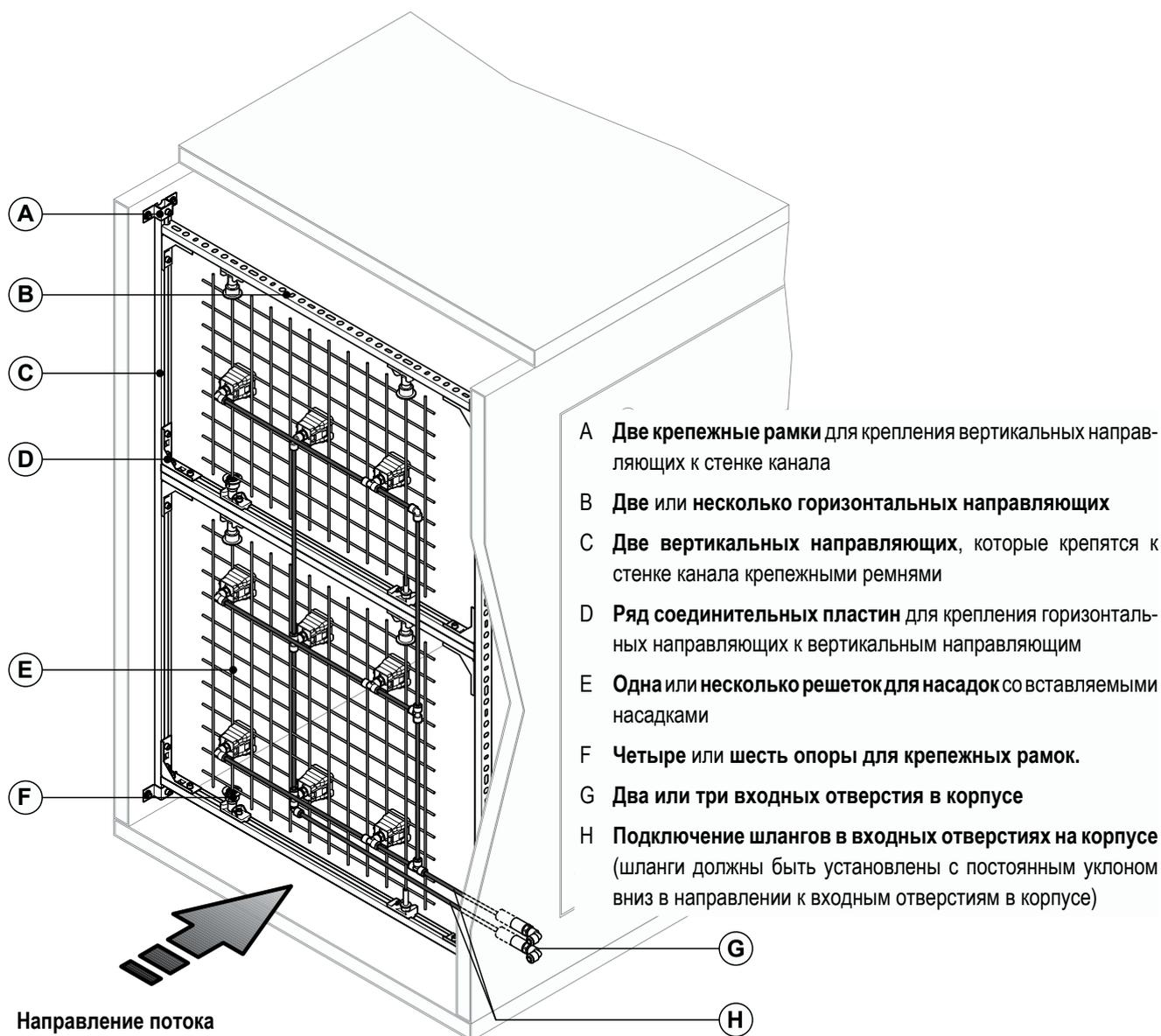
Прежде всего, закрепить две вертикальные направляющие на обеих сторонах канала (расположение и крепление см. на установочном чертеже).
