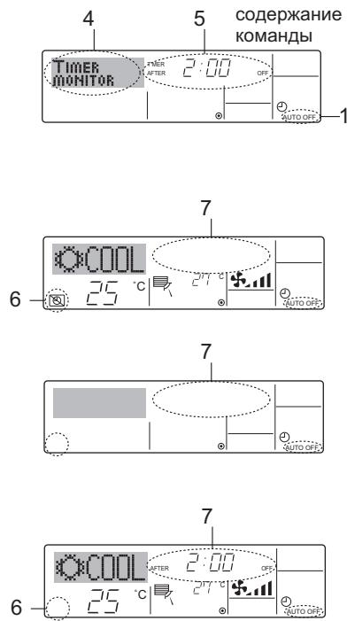
5. Нажмите кнопку «Mode (Return)» для выхода из режима настройки таймера и перехода к режиму управления.
