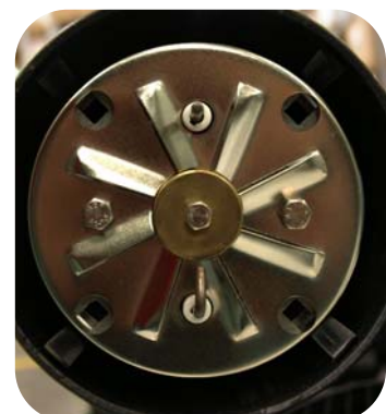
12- Установить обратно стакан горелки.
