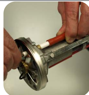
4- Снять провод зажигания и ионизации.
