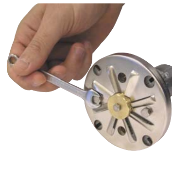
8- Вывинтить крепежные винты и снять рассекатель (ключом на 8 мм).
