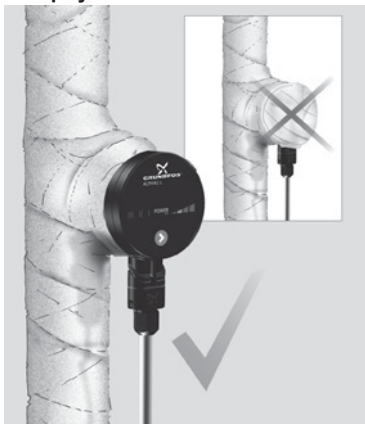
Рис. 6 Изоляция корпуса насоса
