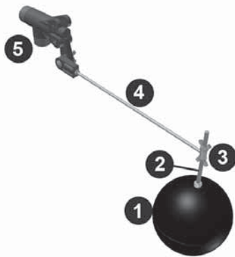
Рисунок 2: Узел клапана подпитки водой
