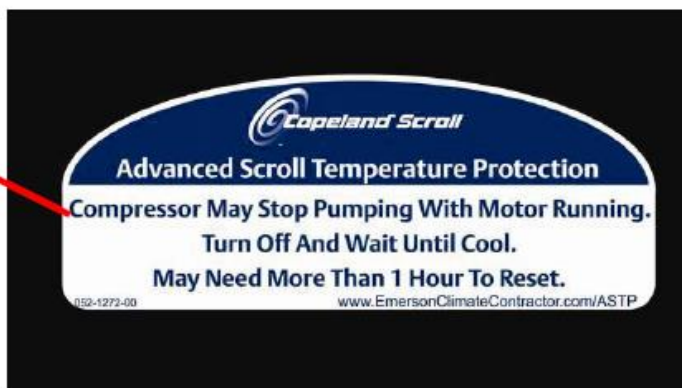
Рис 14: Прогрессивная тепловая защита спирального компрессора (ASTP)
