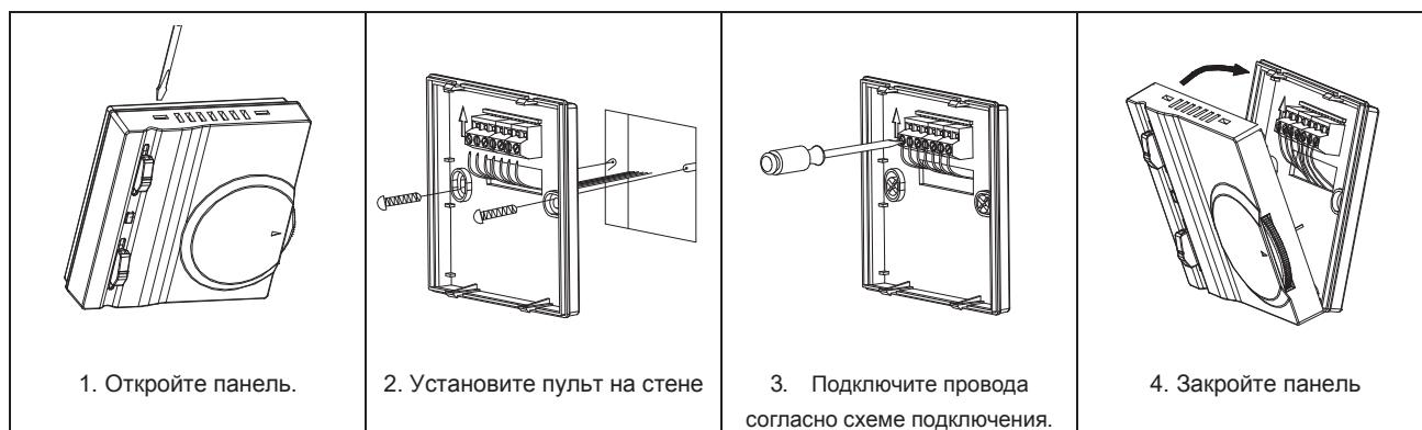
**Внимание: Пульт должен подключаться специалистом в строгом соответствии со схемой подключения. Не допускайте попадания воды и грязи для предотвращения поломок.**
