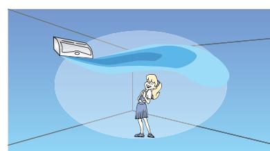
В режиме обогрева теплый воздушный поток направляется почти вертикально вниз для более интенсивного кондиционирования воздуха в помещении.
