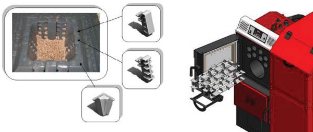
Извлечение турбулизаторов из котла ECO COMFORT
