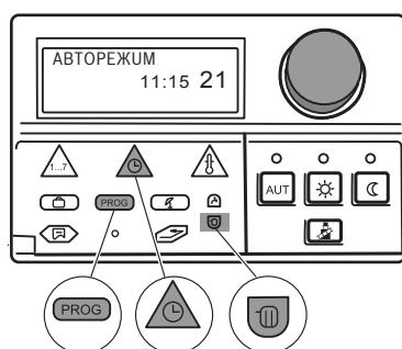
Если Вы внесли изменения в стандартную программу или ввели полностью новую программу, то система управления сохраняет введенные данные под названием "COGCTB. 1" для отопительного контура 1 и "COGCTB. 2" для отопительного контура 2.
