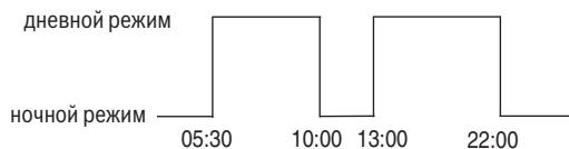
Рис. 14 Установка точки переключения
