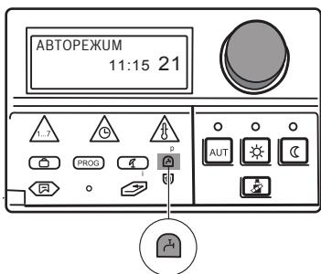
С помощью системы управления Logamatic 2107 можно экономично нагревать воду для контура горячего водоснабжения. Для этого предусмотрено приготовление горячей воды по таймеру. Вы можете включить приготовление горячей воды, установив нужную температуру. Для экономии энергии приготовление воды вне запрограммированных временных интервалов отсутствует.
