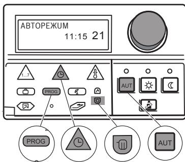
Отопительный период подразумевает два значения времени переключения: одного включения и одного выключения. Чтобы объединить два отопительных периода, идущих один за другим, установите время выключения первого отопительного периода на время включения следующего за ним отопительного периода.
