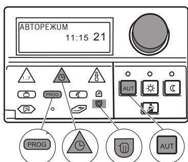
Отопительный период подразумевает два значения времени переключения: одного включения и одного выключения. Если Вы хотите отменить отопительный период, то нужно отменить оба времени переключения.
