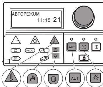
Если два отопительных контура подключены без дистанционного управления, то настройки на системе управления действуют для обоих контуров.
