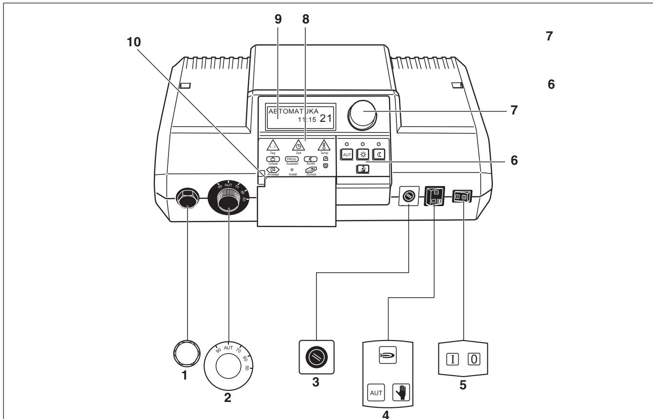
Рис. 4 Элементы управления Logamatic 2107 и Logamatic 2107 M
