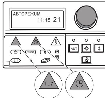
Если установлено дистанционное управление со встроенным приемником радиосигналов (BFU/F), то настройка или корректировка дня недели и времени происходит автоматически.
