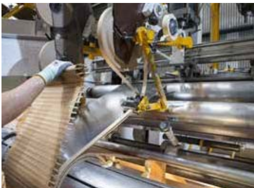
Обмотка НН, изготавливаемая из металлической фольги
