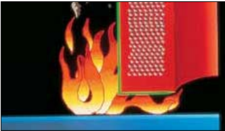
1-й противопожарный эффект: образование отражающего огнеупорного экрана из глинозема (окись алюминия)
