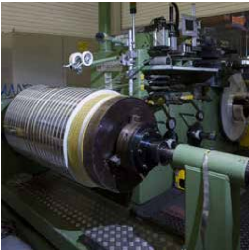
Обмотка ВН, изготавливаемая из металлической ленты
