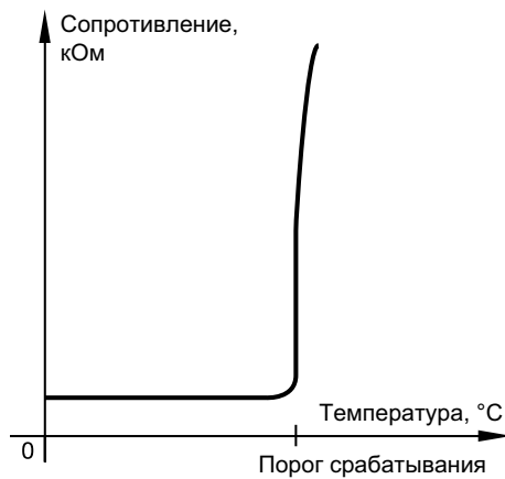
Типовой график датчика PTC
