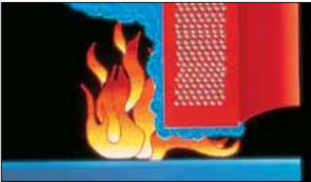
2-й противопожарный эффект: образование преграды из водяного пара
