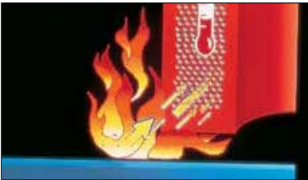
3-й противопожарный эффект: поддержание температуры ниже точки воспламенения
