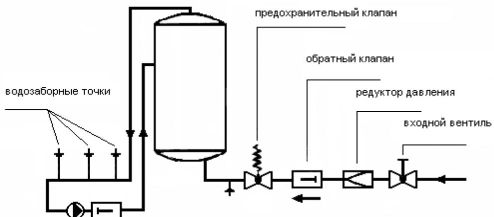
Схема обвязки водонагревателя с линией циркуляции
