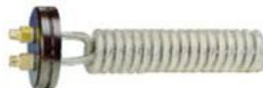
Вода может быть нагрета от котельной установки либо от альтернативных источников тепла типа солнечных установок и тепловых насосов или от городской системы центрального отопления. Теплоноситель подается насосом от первичного нагревателя и проходит через теплообменник. Трубчатый теплообменник устанавливается горизонтально в резервуаре водонагревателя и поэтому со всех сторон омывается водой, которая должна нагреваться.
