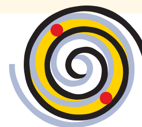
Принципиальная схема спирального блока компрессора ZH с впрыском пара
