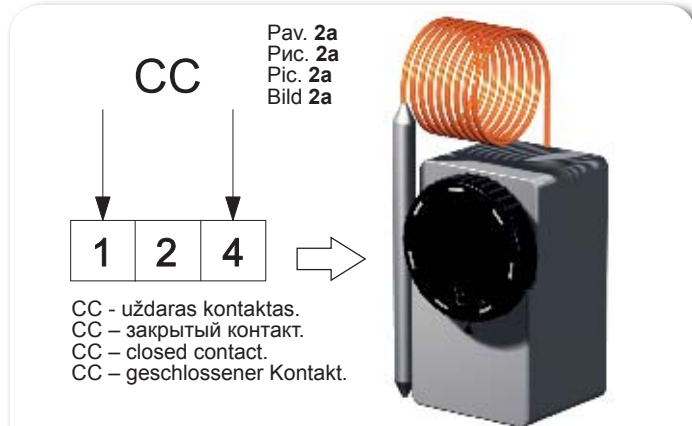
Prieššaliminio termostato patikrinimas. Проверка противозамерзающего термостата. Inspection of the antifreeze thermostat. Überprüfung des frostbeständigen Thermostates.
