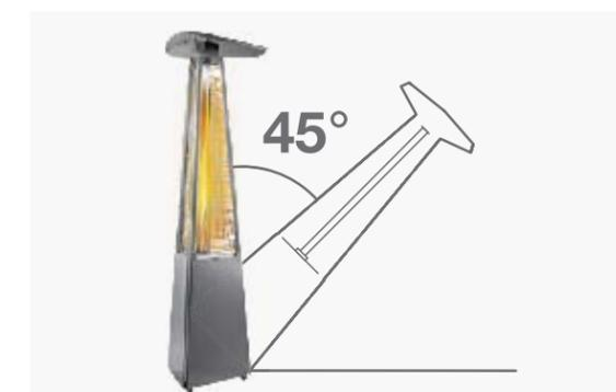
Автоматическое отключение при падении
