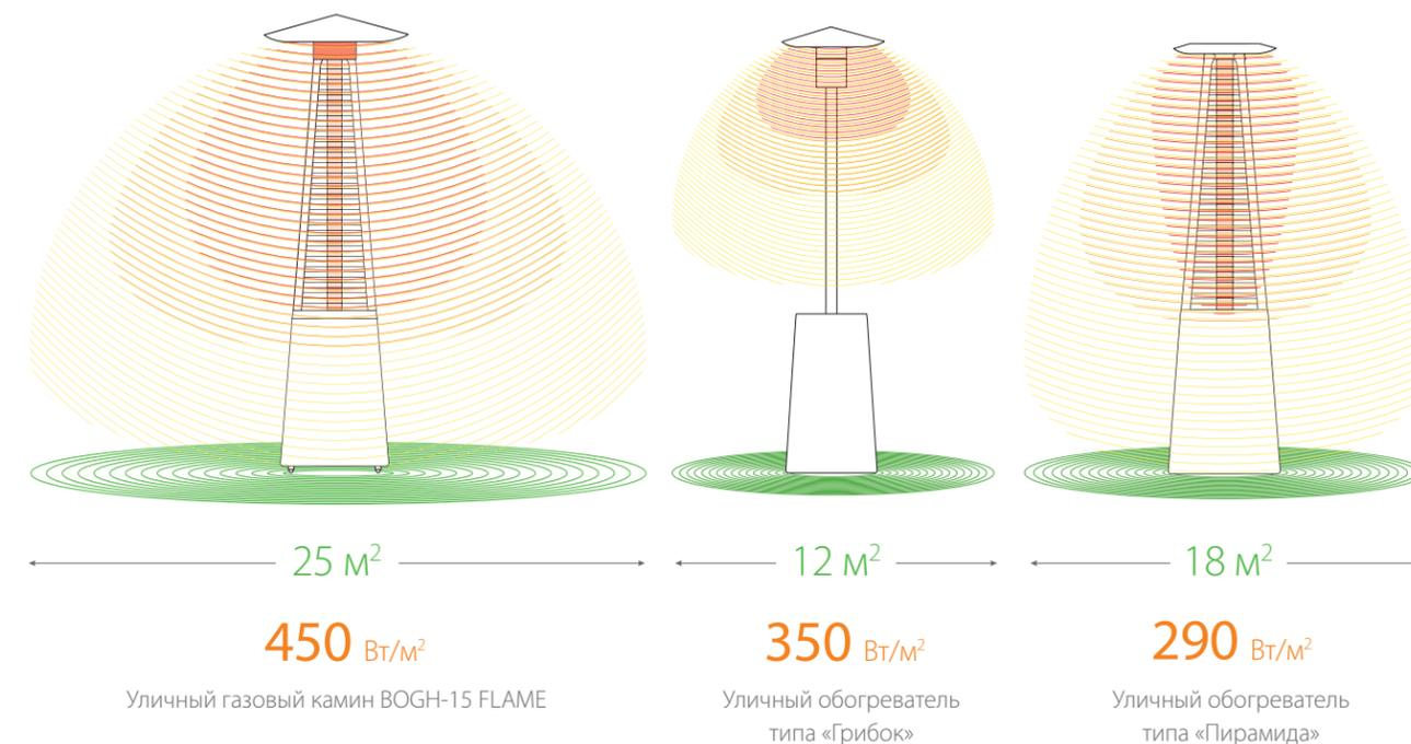
Ключевой показатель, характеризующий эффективность уличного ИК обогревателя — плотность теплового потока (Вт/м²). Он показывает, сколько тепла может отдать прибор на определенную площадь\*.
