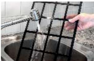
2. Прежде чем установить фильтр предварительной очистки на место, дождитесь его полного высыхания.
