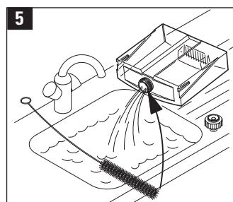
**Limpieza del depósito de agua y de la bandeja inferior - Limpieza del ISS (10)**
