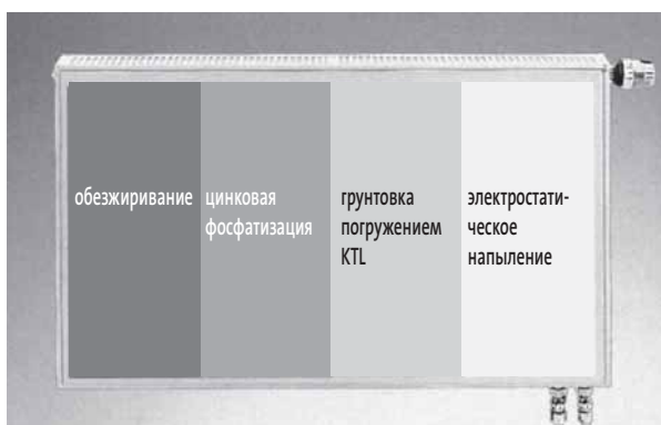
Подготовка поверхности радиатора
