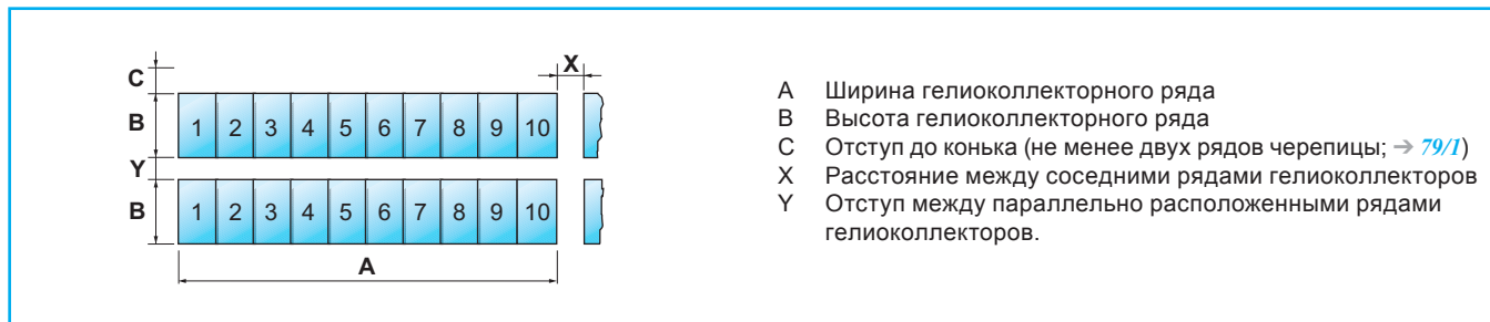
80/1 Необходимая площадь для гелиоколлекторных полей с гелиоколлекторами Logasol при монтаже в кровлю и поверх кровли (габаритные размеры → 80/2)
